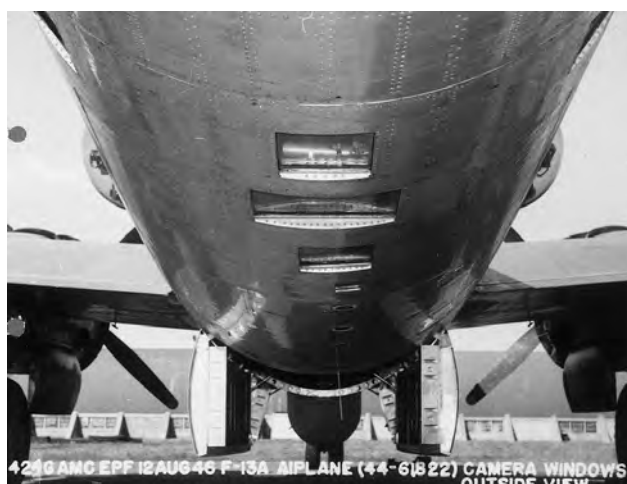
写真-2 F-13 の胴体下部に設置された撮影用の窓
